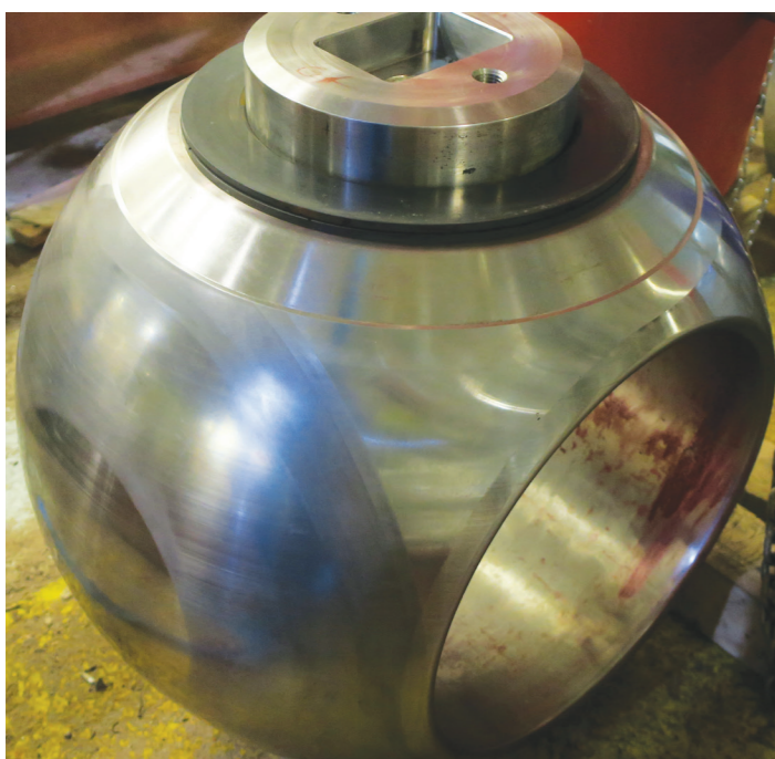
Bildet viser kulen fra den overholte ventilen.
